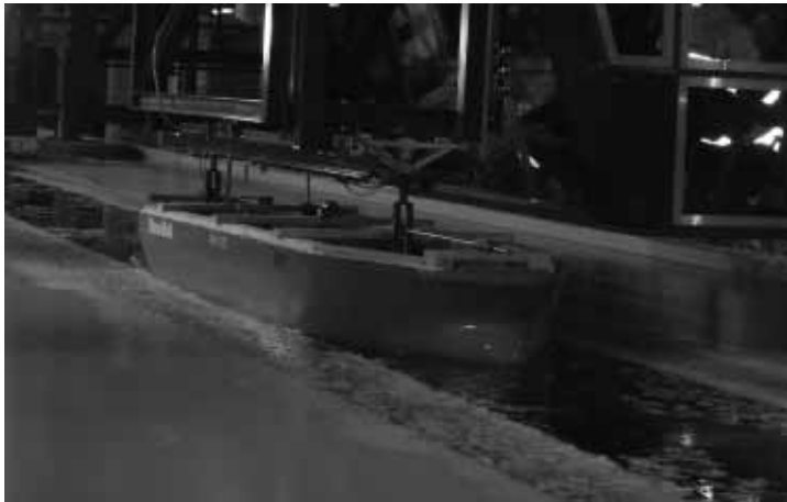
Испытания макета нового танкера «В-Мах» в ледовом бассейне B-Max ice model test
